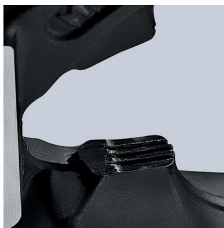
Специальная площадка под шарниром для захвата и протяжки проволоки диаметром свыше Ø 1,0 мм
