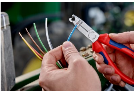
с отверстиями для удаления изоляции с проводов 1,5 и 2,5 мм 2
