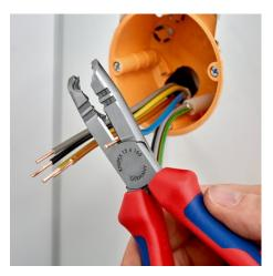
Укорачивание отдельных проводов до одного размера
