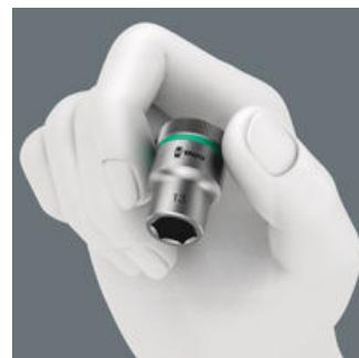
Головки Zykllop подходят для ручного и машинного режима (неударного действия). Они снабжены канавкой под шариковый фиксатор и рифлением по заднему краю для уверенного хвата при использовании головки в ручном режиме. Изготовлены из хромованидийевой стали, с матовым хромированным покрытием. Идентификатор инструментов Take it easy: цветовая кодировка и маркировка размера - для простого и быстрого отбора нужной головки.
